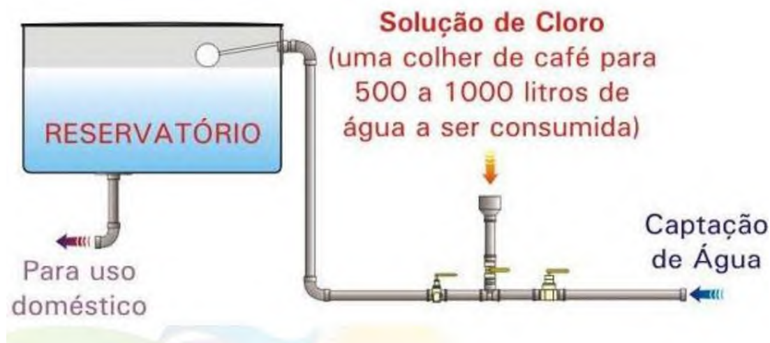
Figura 4 - Instalação de Clorador Embrapa na Rede de Captação de Água.
